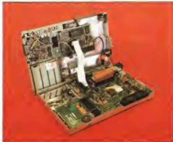
I 160 Kbytes di Canon FX-07 sono a disposizione in un unico microcchip ed il sistema di memoria è ampliato solo.
